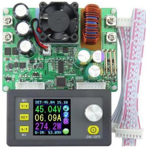
სურ. 5 DPS5015, იმპულსური ლაბორატორიული კვების წყაროს მოდული [9]
