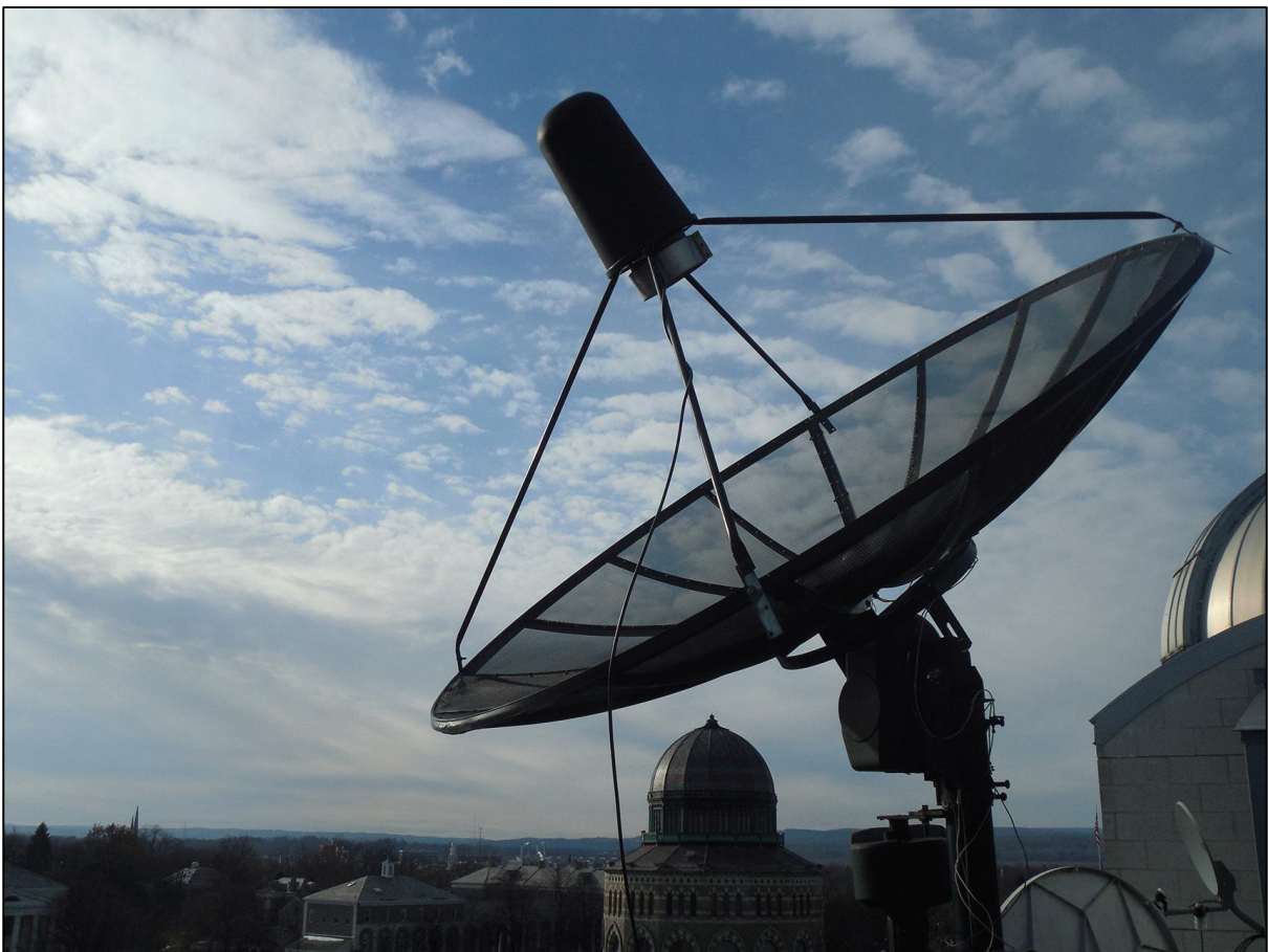
სურათი 1. პირველადი ფოკუსის რადიო ტელესკოპის მაგალითი; ფედერაციის კოლეჯის ჰეისტაკის მცირე 2-მეტრიანი რადიო ტელესკოპი მასაჩუსეტსის შტატში.
