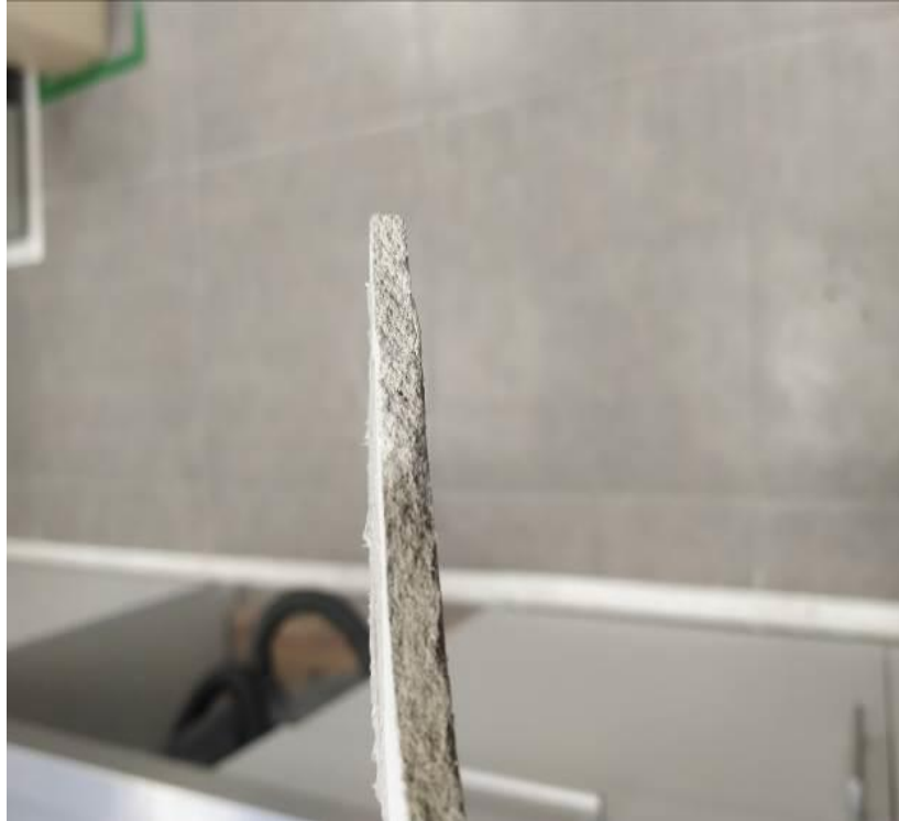
სურათი 18 . სურათის მიხედვით ვხედავთ რომ წყალმა სრულად გაჟონა.
