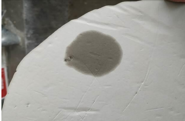
სურათი 21: მეთილსილიკატმა მოგვცა უარყოფითი შედეგი, წყალმა კომპოზიტში შეაღწია
