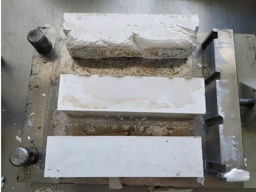
სურათი 24: ფორმები, (ქვემოდან ზემოთ) 1% 2% 3%, 3% იანი თაბაშირი იმდენად სწრაფად შრება რომ ფორმაში მისი გასწორება შეუძლებელია
