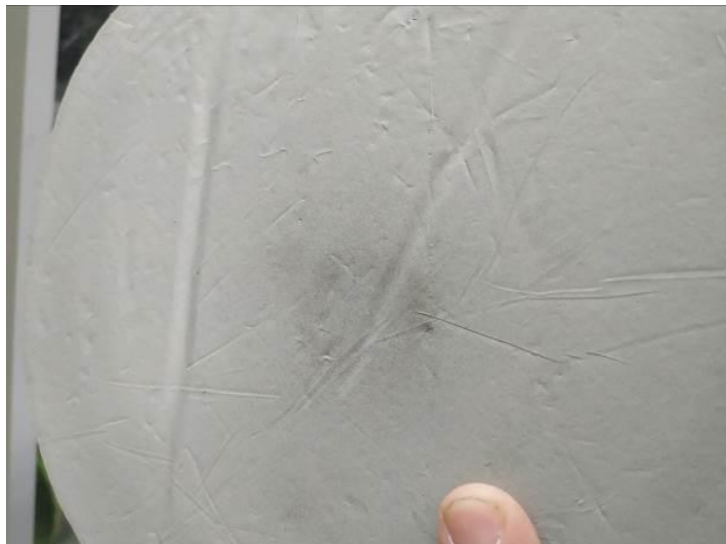
სურათი 20: დამუშავებულმა კომპოზიტმა დადებითი შედეგი გამოავლინა, წყალმა არ შეაღწია კომპოზიტში
