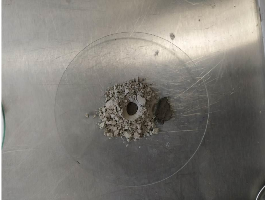
სურათი 6. ტეტრაეტოქსისილანი ვიზუალურად არ შედის რეაქციაში ცემენტთან
